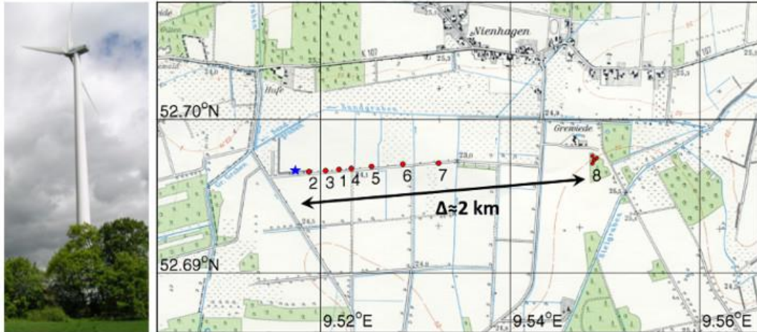
Abbildung 1: Feldmessungen an einer 200 kW Windkraftanlage vom Typ Vestas V47 nördlich von Hannover. Die Registrierung mit MB2000 Mikrobarometern erfolgte entlang eines etwa 2 km langen Profils Quelle: BGR
